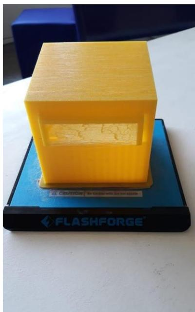
Para o produto final, foi utilizado uma impressora 3d para imprimir a caixa do equipamento, pois o protótipo era feito com papelão e estava em risco de se molhar com a chuva e a irrigação, destruindo os componentes eletrônicos. A caixa foi impressa com material PLA, o que torna o projeto resistente a chuvas.
